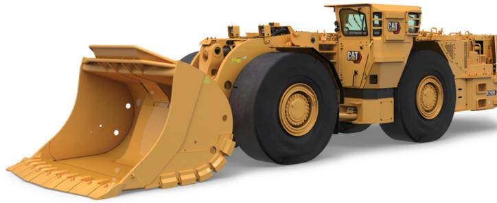
**Figura 1.1:** Máquina LHD modelo R2900G producida por Caterpillar.
