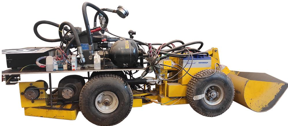
**Figura 5.5:** Máquina LHD a escala utilizada para experimentos en mundo real.
