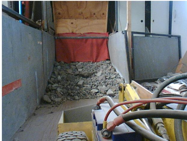
**Figura 5.8:** Ejemplo de vista que tiene el operador al efectuar un carguío teleoperado.
