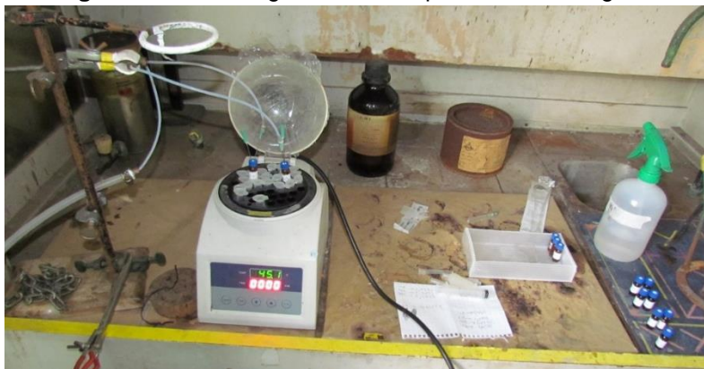
Figura 4.19. Secado de las muestras por flujo de nitrógeno.
