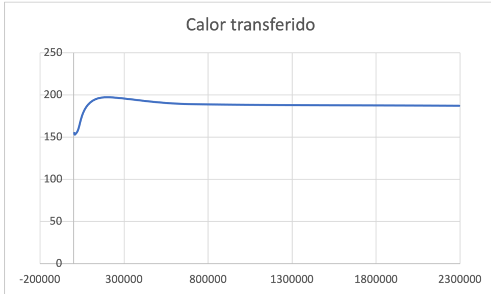
Figura 3.14: Convergencia de calor respecto a cantidad de elementos.
