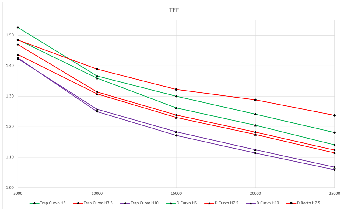
Figura 4.87: Curvas de rendimiento térmico para todos los modelos estudiado, Re = 5000 a 25000.
