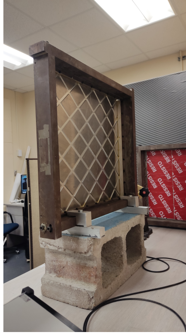
Figura 3.2: Placa montada a un marco con procedimiento para aproximar condiciones de borde a un apoyo simple
