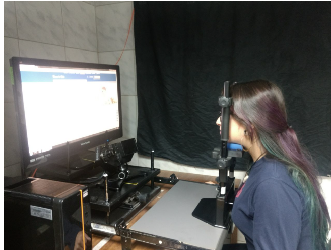
Figura 9. Esquema del sistema Eye-Tracker, modelo EyeLink 1000. El sistema cuenta con una pantalla, una cámara infrarroja, un emisor de luz infrarroja y un soporte para mantener la cabeza estática durante el experimento.
