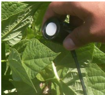
Figura 2. Ejemplo de la posición del radiómetro paralelo al folíolo central.
