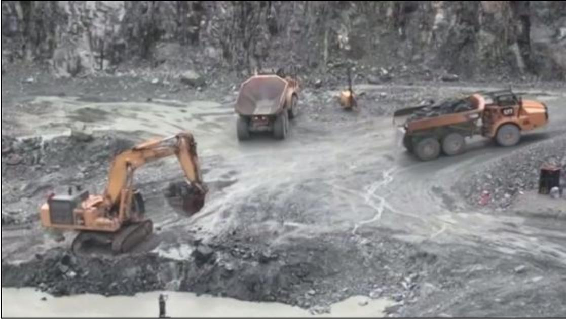
**Figura 4: Mina en Centroamérica con alta interferencia de agua en la operación de carguío.**
