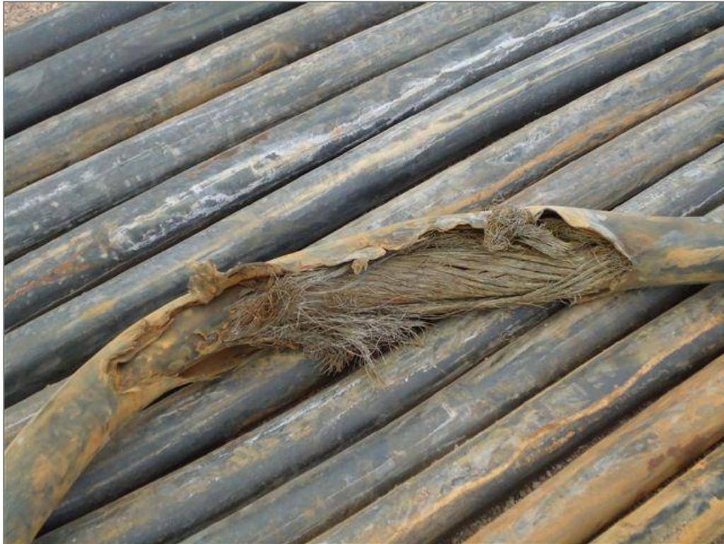
**Figura 60: Ejemplo de daño en cable por habilitación muy ajustada en relación con el diámetro del conjunto motor-bomba-cables**
