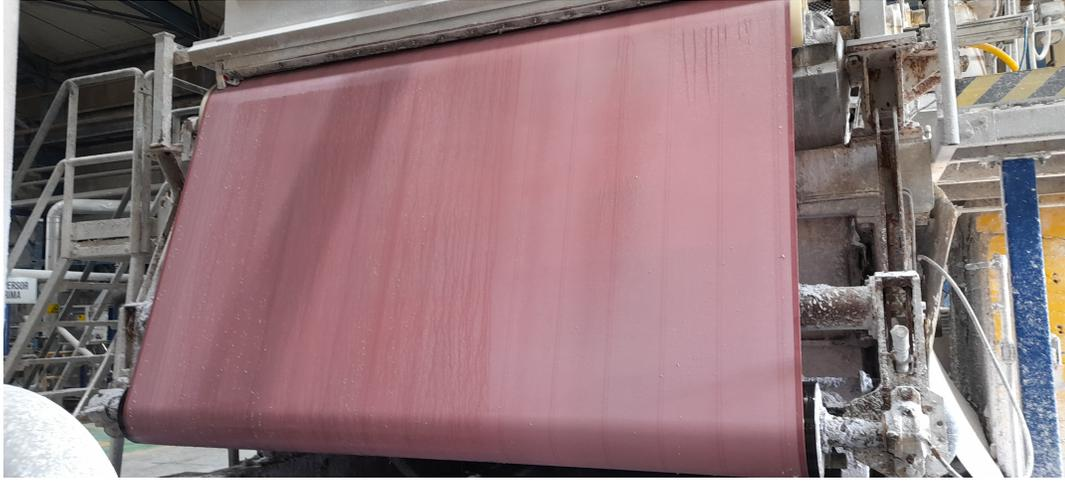
Figura F.2: Tela de la Prensa limpia directamente bajo la caja de nivel.
