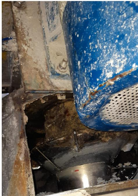
Figura F.1: Cabezal cónico del Tornillo 50 en uso. Elaboración propia.
