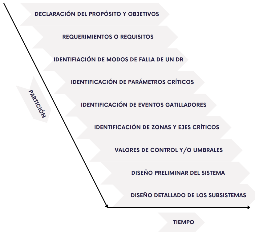
Figura 5.2: Diagrama semi-V aplicado al sistema de monitoreo de depósitos de relaves activos. (Modificado de Fuentes 2010)
