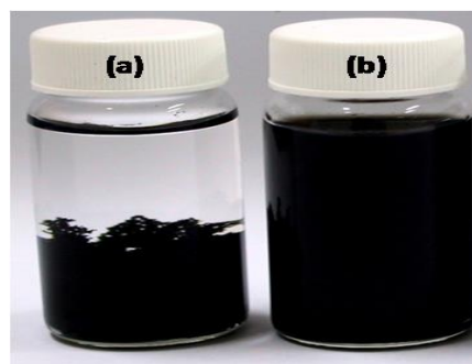
Figura 4. Dispersión de MWCNT. (A) Baja estabilidad de la dispersión de nanotubos, (B) Dispersión estable de los nanotubos 29 .
