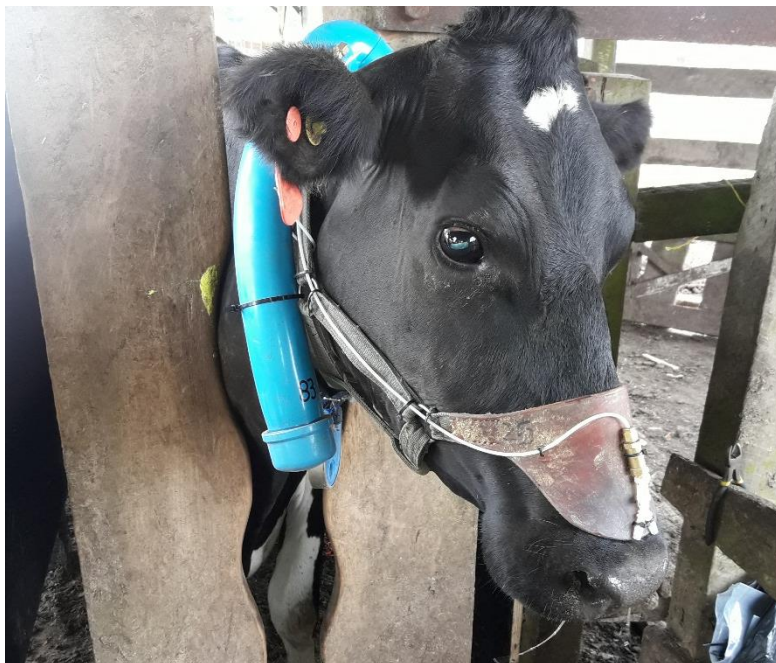
Figura 2: Vaca con collar, jáquima y línea de muestreo para la medición de CH 4 entérico de acuerdo a la técnica SF 6 .
