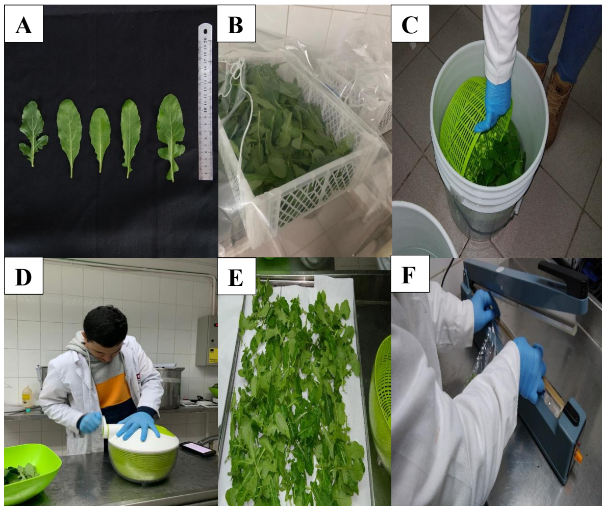
Figura 2. Etapas del procesamiento de las hojas de rúcula: selección y caracterización de las hojas (A), recepción en bandejas (B), lavado y sanitizado (C), centrifugado (D), escurrido (E) y embolsado (F).
