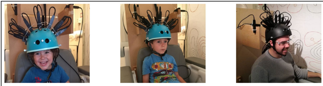
Figura 3. Sistema MEG. Configuración experimental para participantes de 2 años (izquierda), 5 (centro) y 24 años (derecha). Los OPM, alojados en un casco de bicicleta modificado, median la señal MEG. Figura extraída de Hill et al. (54).
