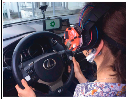
Figura 9. Participante en prueba de conducción de vehículo real. Se muestra una participante usando los auriculares EEG de Biohub y realizando la sesión de conducción de un automóvil. Afirmada desde el parabrisas, se observa la pantalla que presentaba los distintos estímulos visuales (íconos) de la prueba. Figura extraída de Ascari et al. (84).
