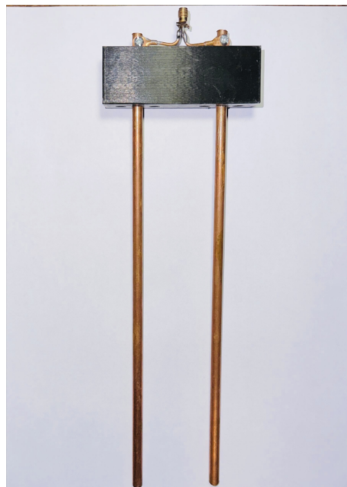
Figura 3.6: Línea de transmisión de 25 cm. con separador plástico utilizada en la mediciones de suelo.
