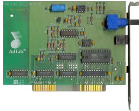
Figura 3: Primera tarjeta de sonido ad lib Yamaha YM3812.
