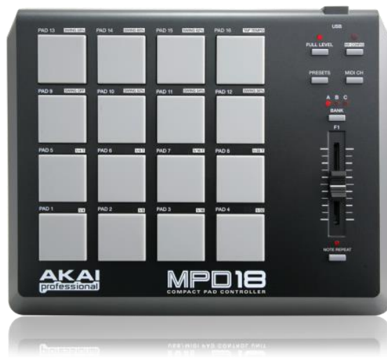
Figura 12: Controlador MIDI tipo PAD Akai MPD18
