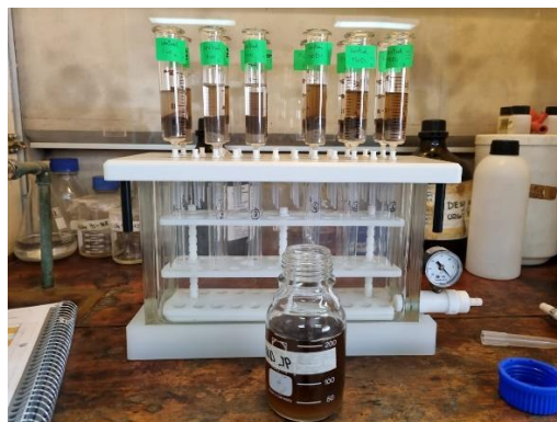
Figura 11: Columnas de suelo conectadas al sistema de extracción al vacío
