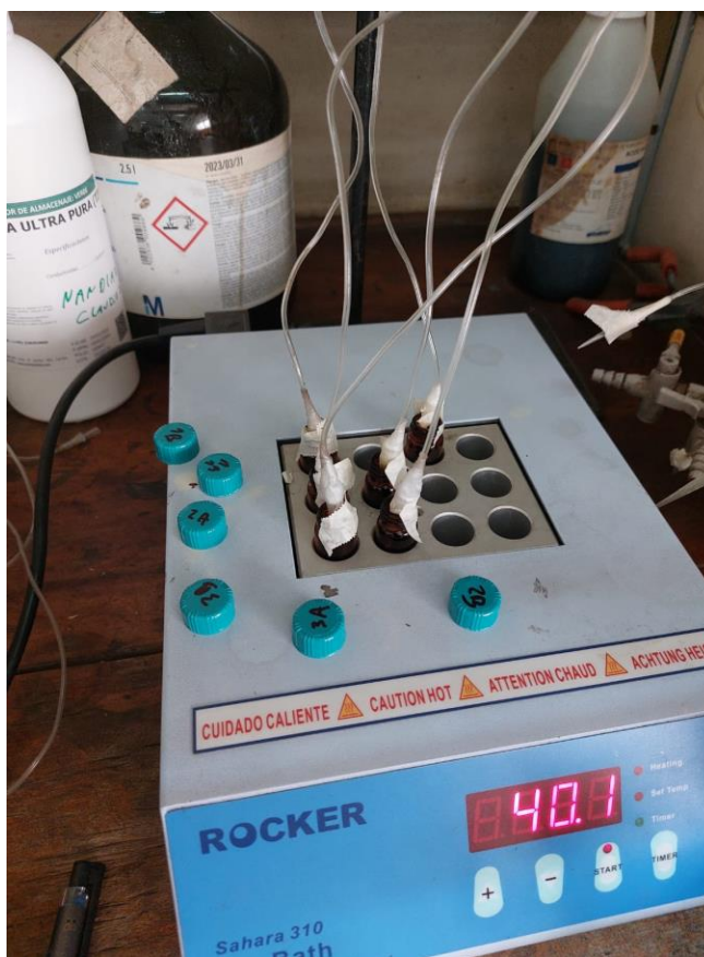
Figura 9: Proceso de secado en baño seco con corriente de nitrógeno.
