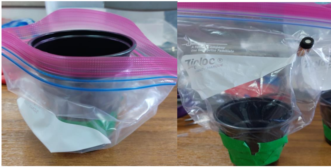
Figura 10: Sistema de interacción para el suelo-biosólido-diésel previa adición de suelo.
