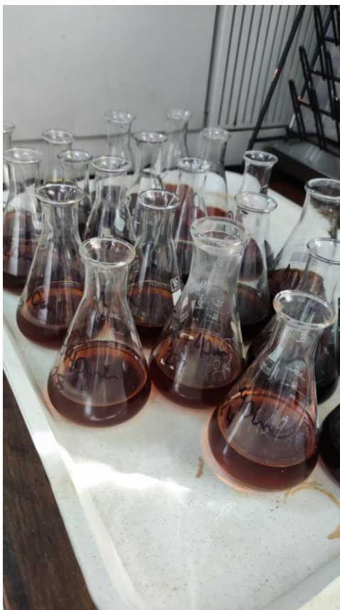
Figura 5: Matracas Erlenmeyer utilizados para la medición de Carbono Orgánico.
