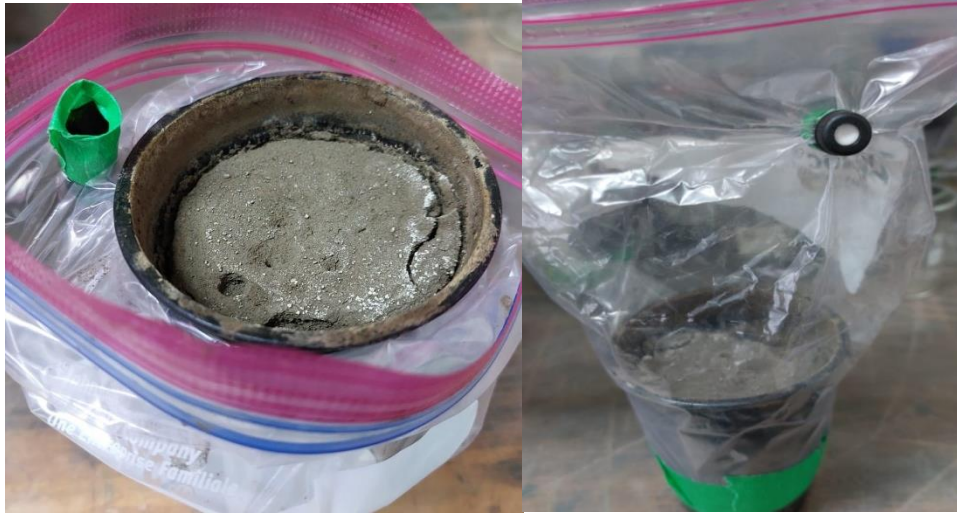
Figura 11: Sistema de interacción para el suelo-biosólido-diésel solo con suelo.
