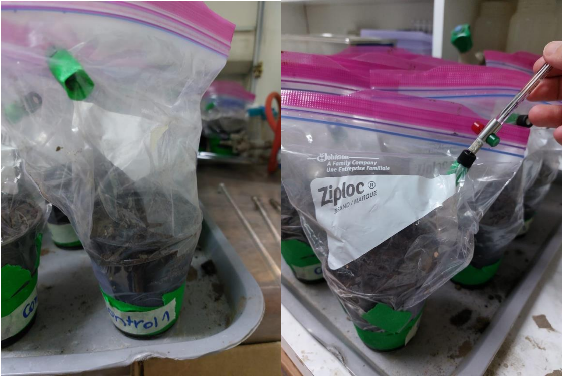
Figura 12: Proceso de extracción de la fase gaseosa de los sistemas de interacción suelo-biosólido-diésel.
