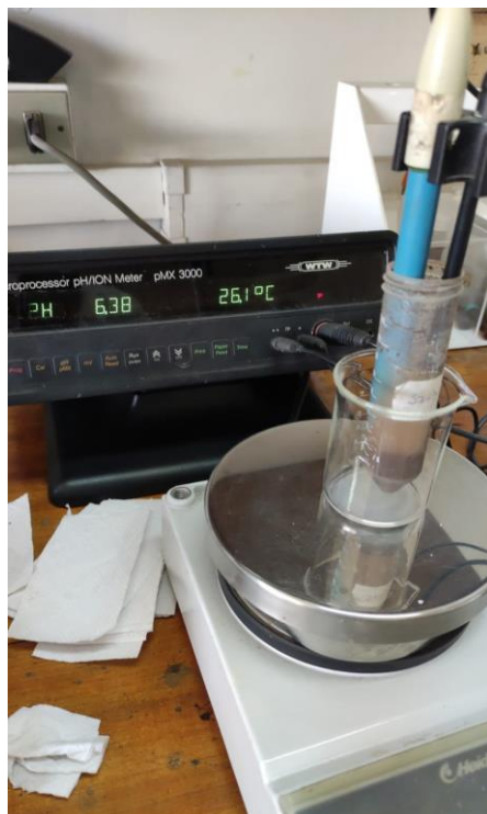
Figura 4: Determinación del pH de suelos utilizando electrodo combinado de vidrio-calomelano
