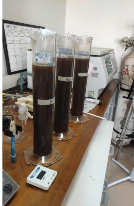
Figura 6: Probetas utilizadas para la medición de texturas de los suelos.
