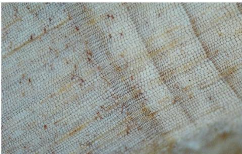
Figura 15: Imagen detallada del cambio en el grosor de los anillos y dirección de las células luego del anillo falso.
