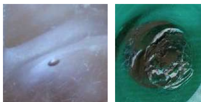
Figura 74: Marcas de manufactura, burbuja (izq.) y marca de puntel (der.). (Fotos de la muestra, autoría propia)
