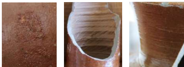
Figura 65: Tipos de marcas de manufactura (Fotos de la muestra, autoría propia)
