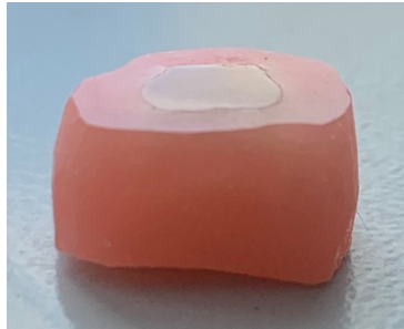
Figura N°2: Muestra embebida en acrílico de autocurado y pulida
