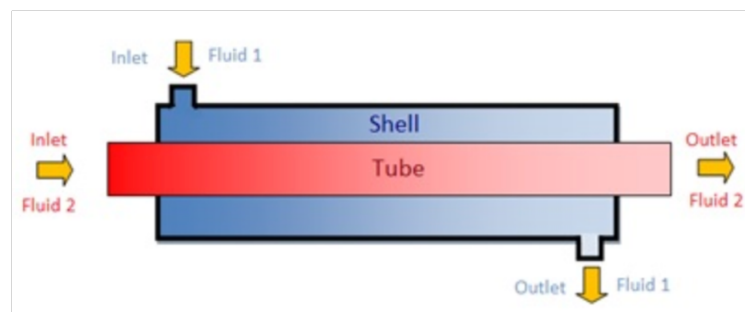
Figura 2.1: Esquema de intercambiador de calor de tubo y carcasa. [17]
