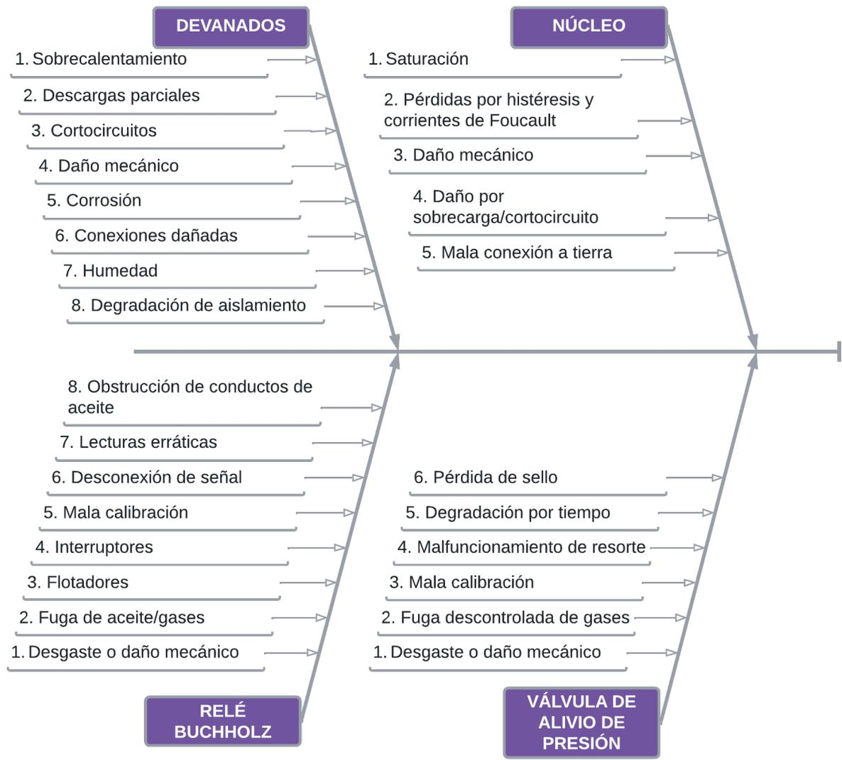
Figura 4.1: Diagrama de Ishikawa de Fallas de Transformadores Eléctricos, Parte 1 [Elaboración propia]
