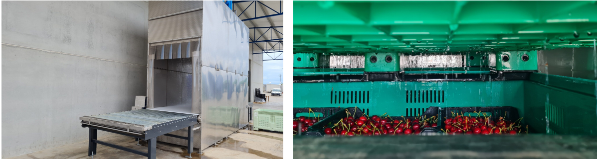
Figura 7.4: Hidroenfriamiento en packing . Fuente: Obtenido de [56].
