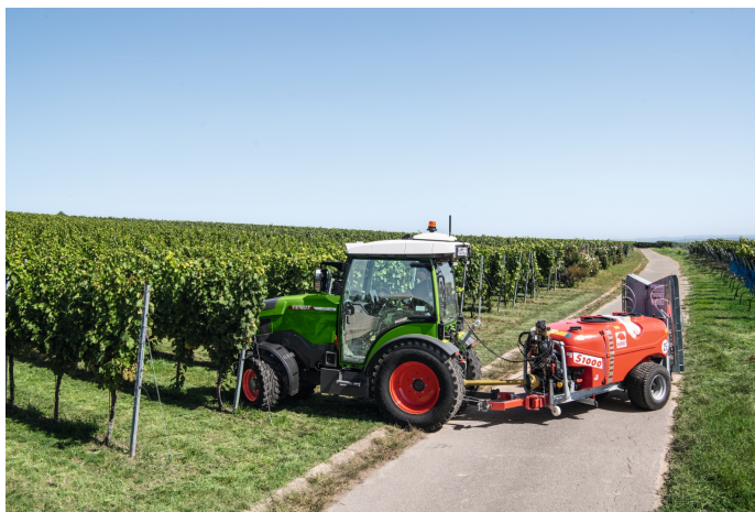
Figura 8.6: Tractor Fendt e100 V Vario equipado con una nebulizadora. Fuente: Obtenido de [60].
