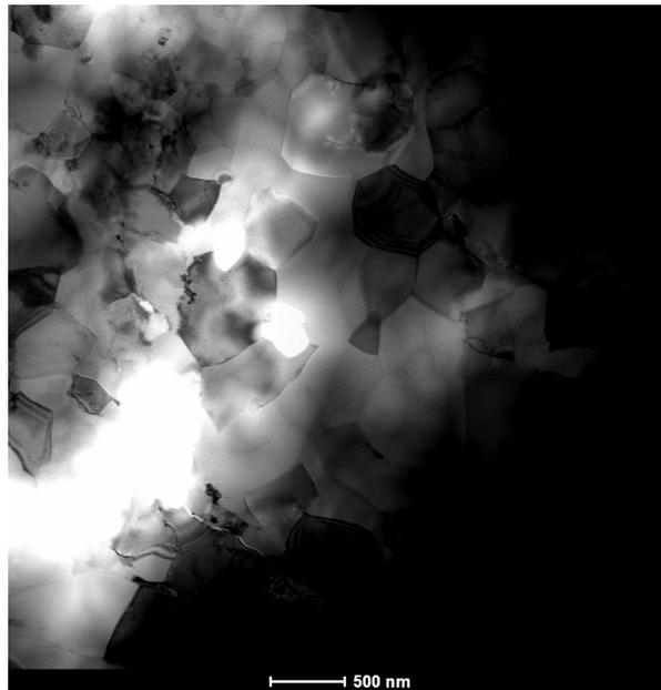
Figura 4.46: Imagen de TEM con 80 wt. %  $Al_2O_3$  esférico.
