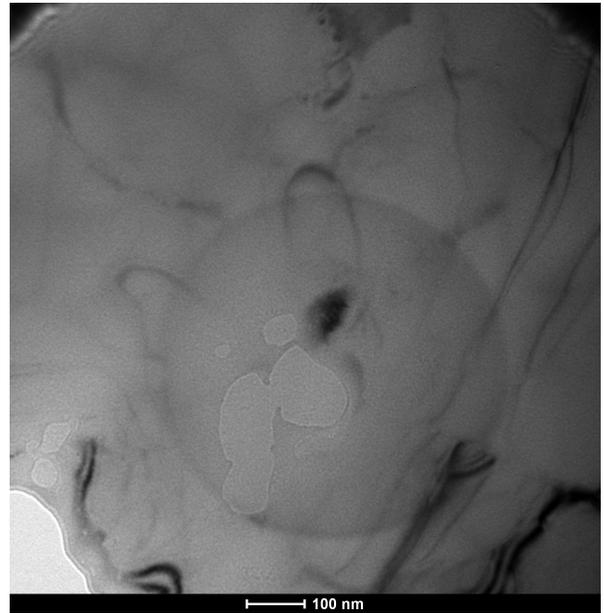
Figura 4.42: Imagen de TEM con 20 wt. %  $Al_2O_3$  esférico.
