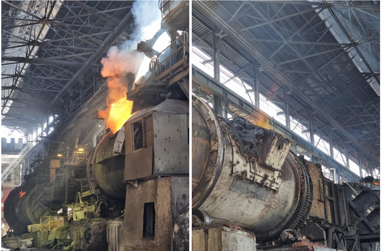
Figura 4.47: Gases que se liberan del Convertidor Peirce – Smith producto de la basculación del horno. (Elaboración Propia, 2023)
