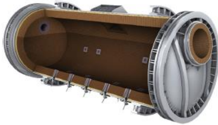
Figura 4.11: Esquema de un horno de ánodos rotatorio utilizado en para el proceso de refino a fuego del cobre blíster. (Schlesinger, Sole, Davenport, & Alvear Flores, 2021)
