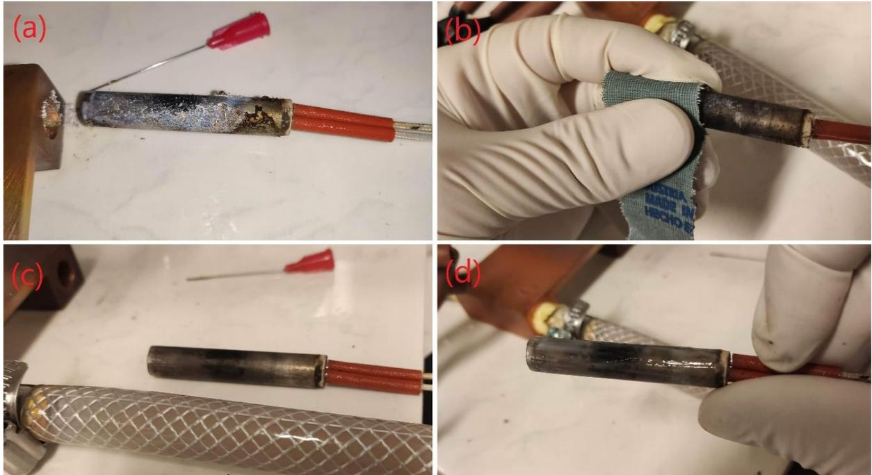
Figura [13.4]: Limpieza y preparación del calefactor de cartucho. Calefactor sucio (a). Lijado del calefactor (b). Calefactor limpio (c). Calefactor engrasado (d).
