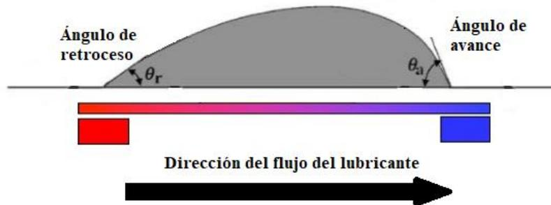
Figura [2.3]: Ángulos de contacto de avance y retroceso para la migración de una gota de lubricante [14].
