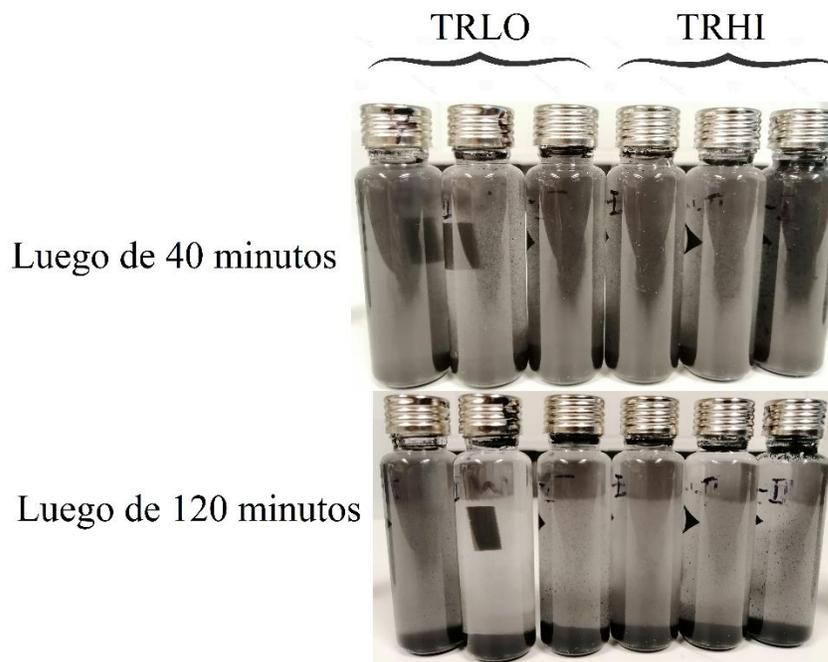
Figura [5.1]: rGO en solución de agua destilada, luego de los tiempos señalados tras baño de ultrasonido. Elaboración propia.
