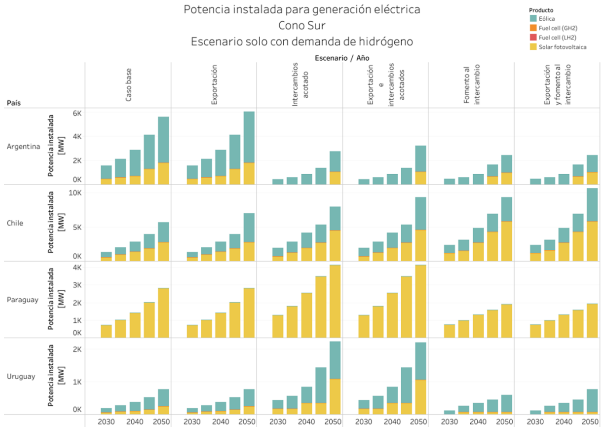
Figura E-55: Potencia instalada para generación eléctrica en países del Cono Sur. Escenarios solo con demanda de hidrógeno.
