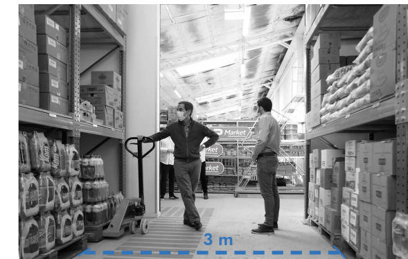
Figura 26. Pasillo de Estanterías Picking Estas estanterías tienen más flexibilidad en cuanto a los anchos requeridos en los pasillos, estos pueden variar entre 1 y 2 metros, y es usual optar por los más angostos para poder aprovechar mejor la superficie y poner más estanterías, los usuarios recolectan los productos con carros. Fuente: EKOS. Dark Stores, un modelo que repunta , 2022. https://ekosnegocios.com/articulo/dark-stores-un-modelo-que-repunta/ (Consultado 12 de Junio 2023)
