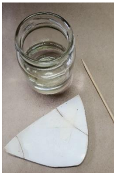
Figura 15. Prueba de resistencia con solución de paraloid con acetona al 50% p/v en fragmento superior (con cinta adhesiva) y al 70% p/v en fragmento inferior.
