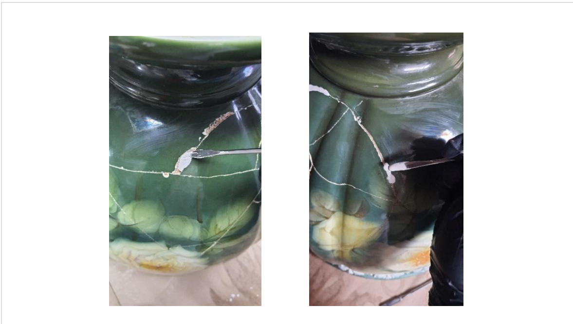
Figura 31. Detalle del relleno de espacios entre fragmentos
