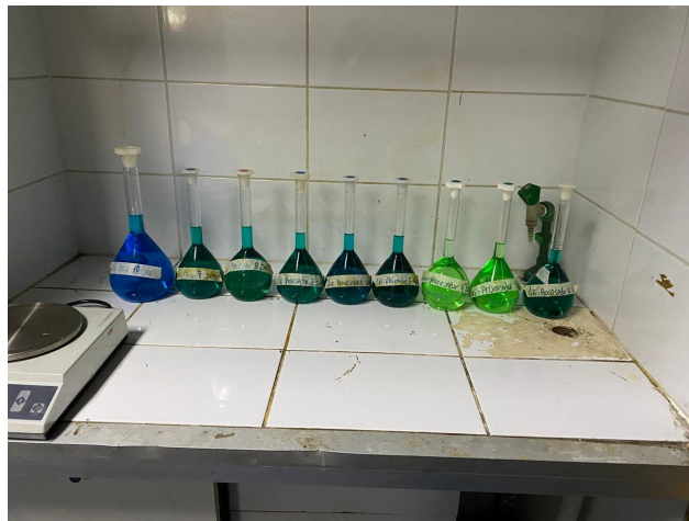
Figura .4: Colorimetría procesadores ya lixiviados.
