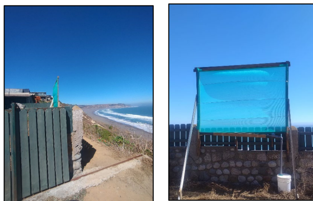
Figura 7: Atrapanieblas de 1,8m de longitud y 1,3m de alto
