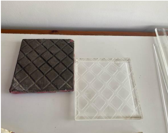
Matrices y reproducciones de baldosa diagonal vereda realizadas en silicona de caucho y hormigón respectivamente.
