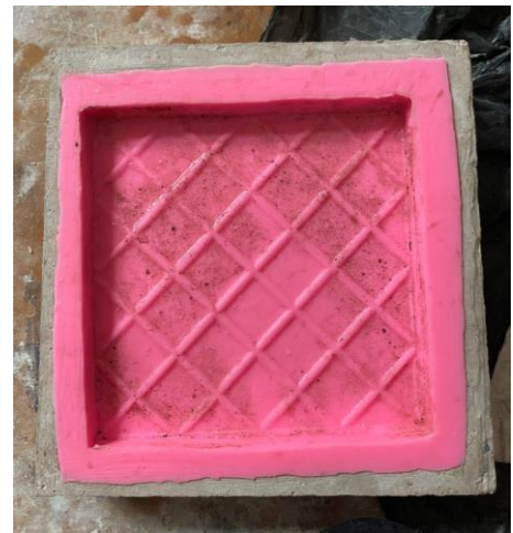
Matrices y reproducciones de baldosa diagonal vereda realizadas en silicona de caucho y hormigón respectivamente.
