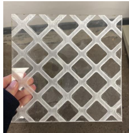
Matrices y reproducciones de baldosa diagonal vereda realizadas en silicona de caucho y hormigón respectivamente.
