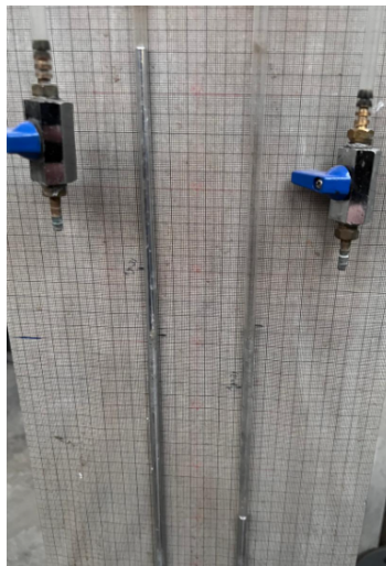
Figura 3.2: Tablero con papel milimetrado para el cálculo del caudal en el canal principal
