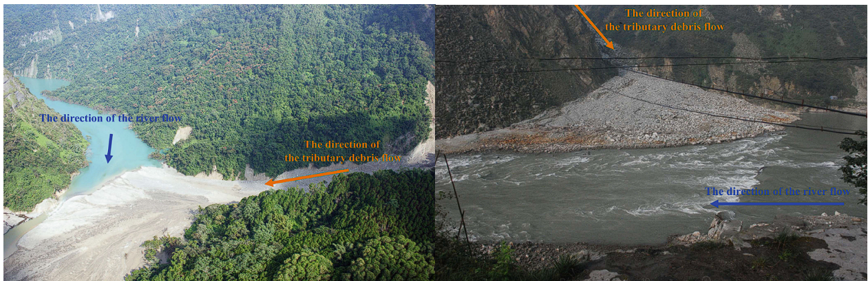
Figura 2.5: Flujos detríticos formando un bloqueo completo del cauce y bloqueo parcial con forma de abanico fluvial (Chen et al., 2019)
