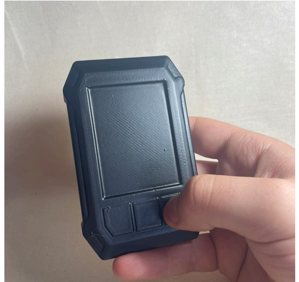
Prototipo físico enfocado forma Medidas: 100x65x19 mm Fabricación: Impresión 3D (PLA) Terminación: Negro mate
