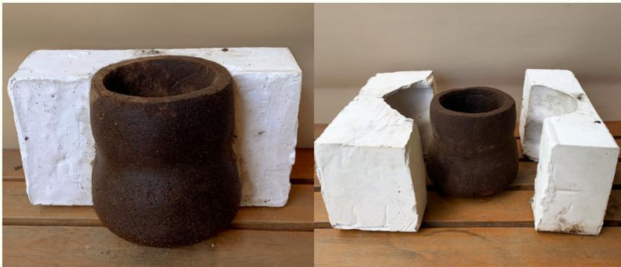
Figura 44. Molde de yeso con el prototipo con el material final. Elaboración propia.
