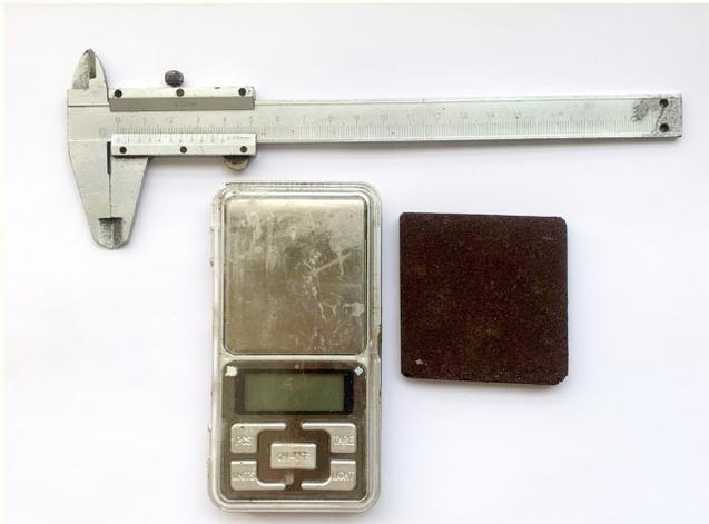
Figura 14. Implementos para medir la densidad, balanza gramera y pie de metro. Elaboración propia.
