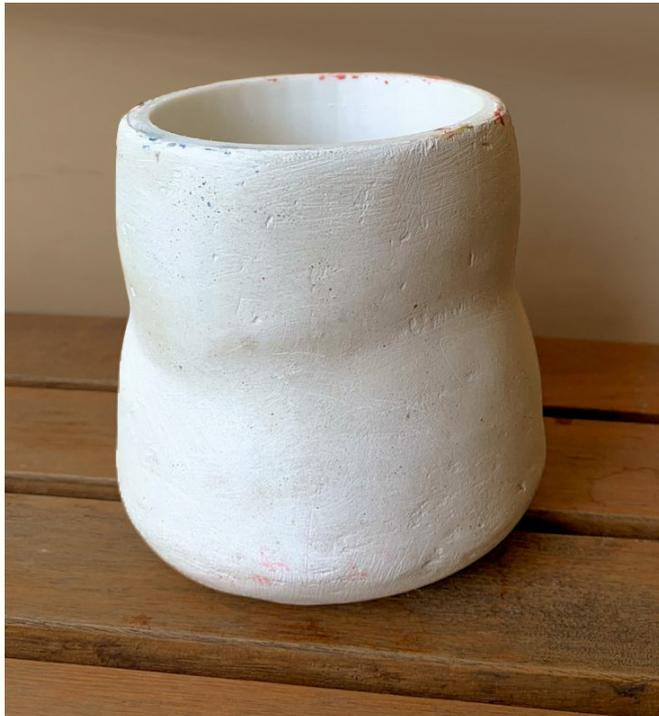
Figura 42. Prototipo PLA después del lijado. Elaboración propia.
