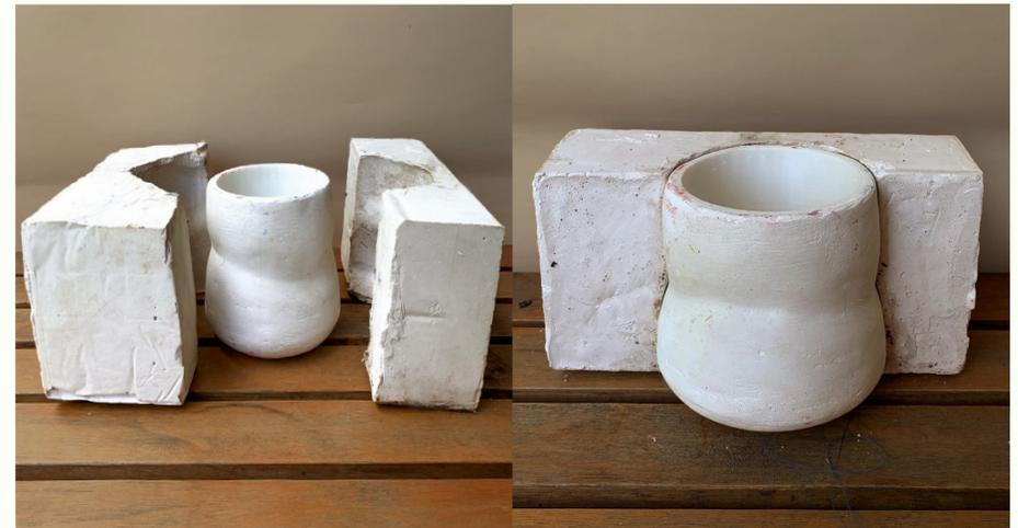
Figura 43. Moldes de yeso elaborados a partir del prototipo impreso en PLA. Elaboración propia.
