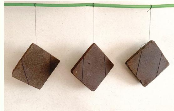
Figura 19. Probetas en la prueba de limpieza colgadas. Elaboración propia.
