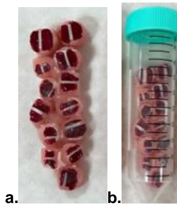
Figura 6-a: Un grupo de 13 muestras unidas aleatoriamente con acrílico de autocurado. Figura 6-b: Un grupo de 13 muestras en tubo falcón de 50 mL.
