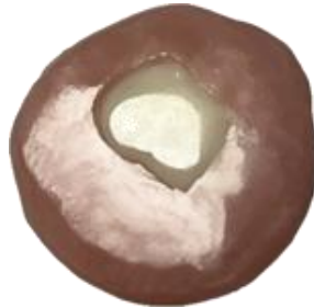
Figura N°4: Muestra en acrílico de autocurado y pulida
